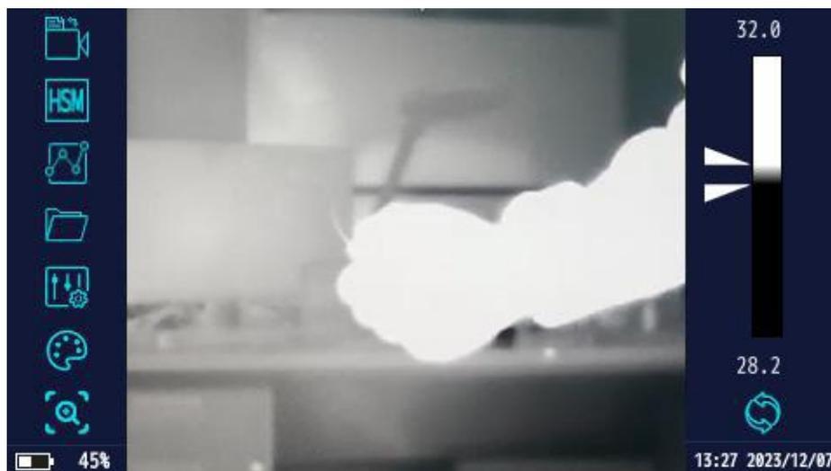
При небольших утечках VOC может обнаружить через газовые облака, чтобы улучшить идентификацию небольших утечек. Однако из-за механизма алгоритма искажения изображения и шумы станут больше. Рекомендуется использовать штатив для фиксации VOC на цели обнаружения. И обеспечить точную фокусировку.
